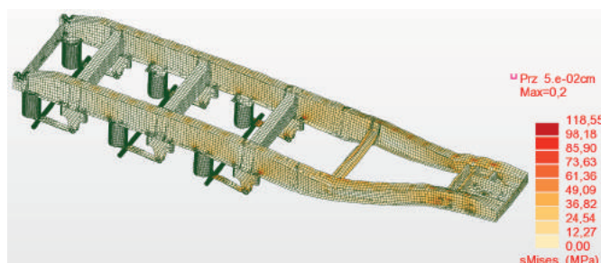
Fig. 5. Rozkład deformacji ramy przy nowym położeniu poprzecznicy
