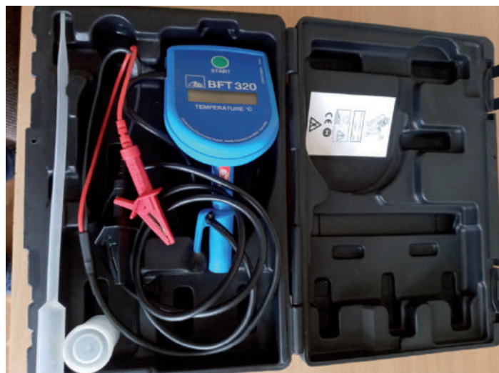
Rys.2. Urządzenie BFT 320 do pomiaru temperatury wrzenia płynu hamulcowego wraz z akcesoriami
