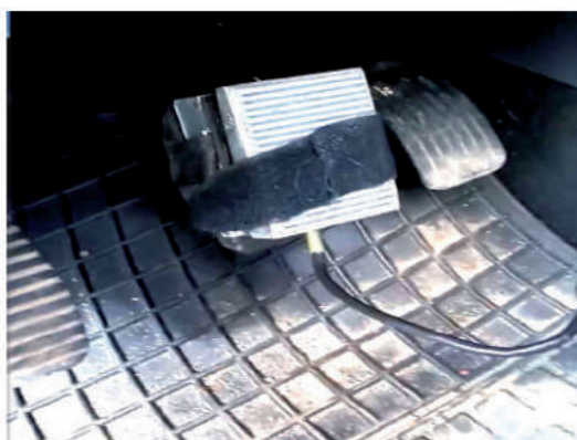
Rys.2. Sposób montażu urządzenia do pomiaru opóźnienia hamowania na dźwigni hamulca
