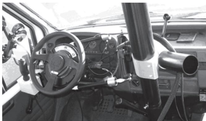
Rys. 3. Widok robota kierującego pojazdem w testach prowadzonych przez
