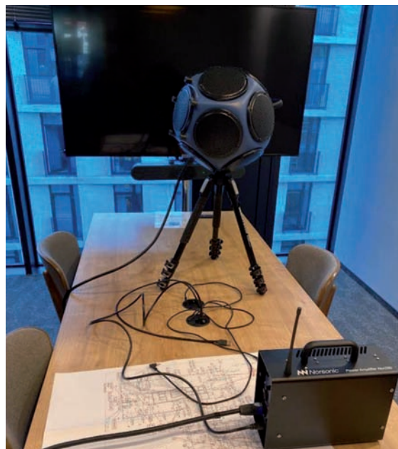
Fot. 1. Lokalizacja źródła dźwięku Dodecahedron loudspeaker Nor276 w analizowanym akustycznie Pokoju Spotkań [opracowanie własne]
