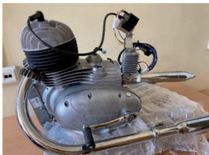
Montaż osprzętu serca motocykla i jego silnik o pojemności 175 cm 3
