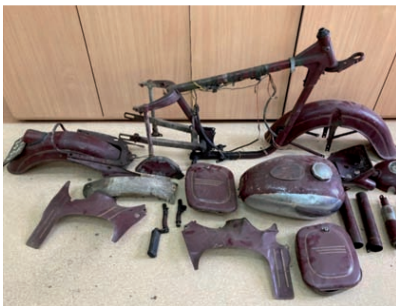
Zdemontowane elementy blacharki Jawy przygotowywane do procesu piaskowania
