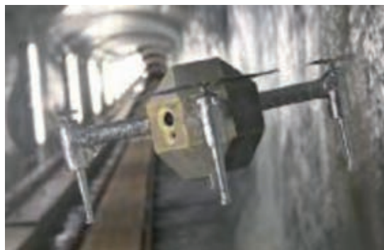
Rys. 2. Testy lotu FireDrone: a) w scenariuszu rzeczywistego pożaru w ośrodku szkolenia strażaków, b) podczas lotów testowych przy niskich temperaturach w tunelu lodowym [9]
