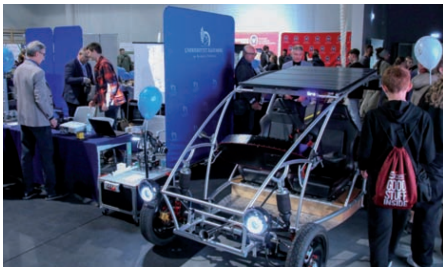
Pojazd z napędem elektrycznym zasilany panelami fotowoltaicznymi, wykonany przez studentów Wydziału Mechanicznego
